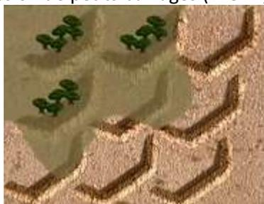
Système de limans israéliens. En gris vert, l'arrivée de l'inondation d'un orage, retenue par les cuvette en demi-lune. Source : Water Harvesting in the Negev, <https://www.youtube.com/watch?v=tjBugtV8GHc>
