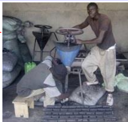
Production du biocharbon avec le Rotor Presstype (© Brades)
