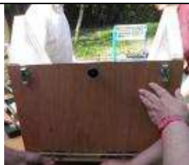
Montage du CSB, lorsqu'on pose sa porte arrière avec des 2 loquets de coffre.
