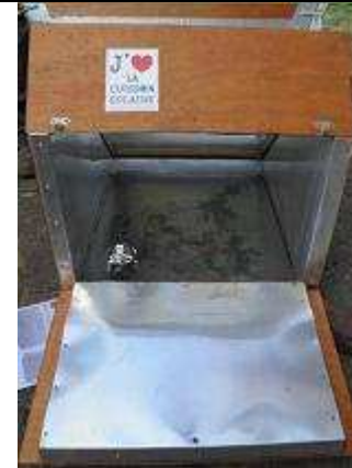
Cuiseur solaire Bolivia-Inti avec sa porte ouverte (à l'arrière).
