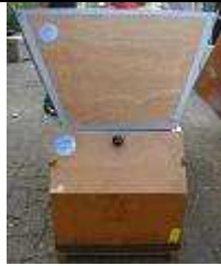
Arrière du Cuiseur solaire Bolivia-Inti (la porte d'introduction des plats est située à l'arrière).
