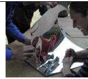
Pose du film réfléchissant type P.E.T. sur le contreplaqué des réflecteurs latéraux.
