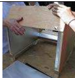
Suite du montage : pose du panneau arrière du haut.
