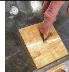
Planche son clou servant de cadran solaire et de repère de l'angle des rayons solaires avec la vitre du cuiseur (on pose ce repère à plat sur la vitre).
